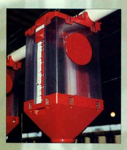
El depósito está construido en una sola pieza, es totalmente transparente, permitiendo en todo momento y desde cualquier posición comprobar el nivel de llenado y el estado del dosificador.
